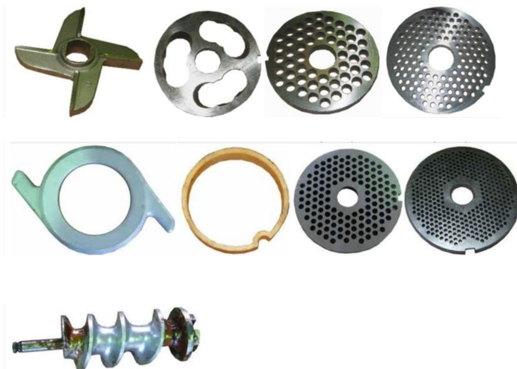
Рисунок 16.6 - Фотографии набора режущих инструментов: а – ноже крестовый; б – нож подрезной; в – решетка с диаметром отверстий 9 мм; г - решетка с диаметром отверстий 5 мм; д – гайка прижимная; е – кольцо упорное; ж – решетка с диаметром отверстий 3мм; з –решетка с диаметром отверстий 3 мм с буртом; к – шнек.
