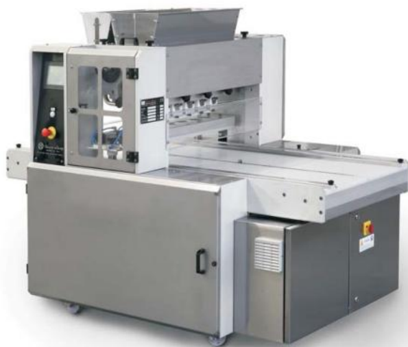
Рисунок 2.6 - Формовочно-экструзионная машина для печенья с начинкой и резаного нитью двухцветного MULTIEXTRUSION и образцы изделий изготовленных
