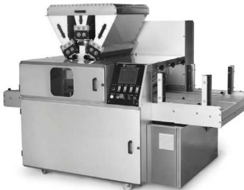
Рисунок 2.9 - Формовочно-экструзионная машина для двухцветного печенья с начинкой и резаного нитью двухцветного ALADIN 600
