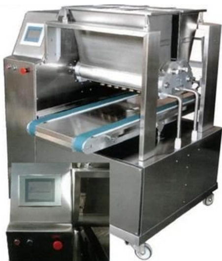
Рисунок 2.5 - Отсадочная машина для производства песочного печенья DAC-600, двухбункерная и насадки
