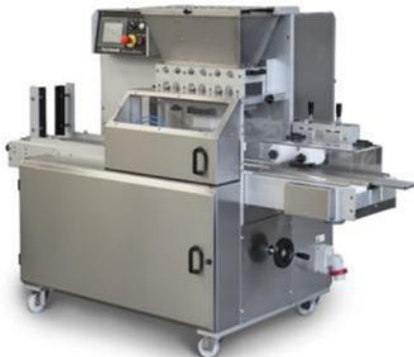
Рисунок 2.7 - Формовочно-экструзионная машина для двухцветного печенья с начинкой и резаного нитью двухцветного ALADIN mini
