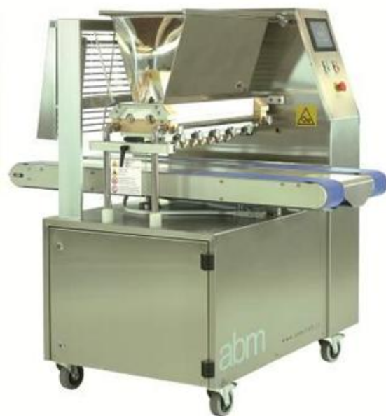
Рисунок 2.2 - Однобункерная тестоотсадочная машина DROP EV TF «ABM»
