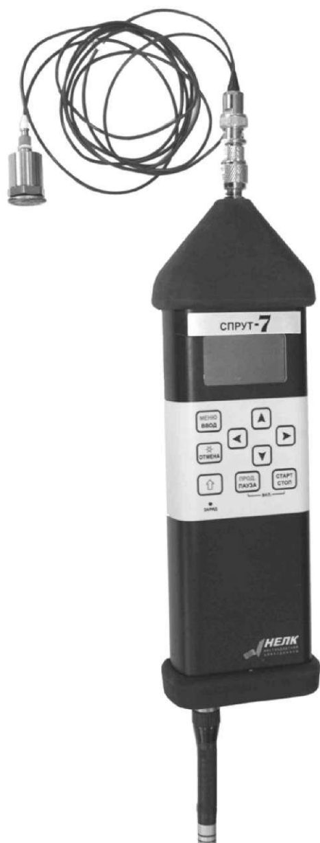
Рис. 7. Внешний вид измерительного модуля с вибродатчиком
