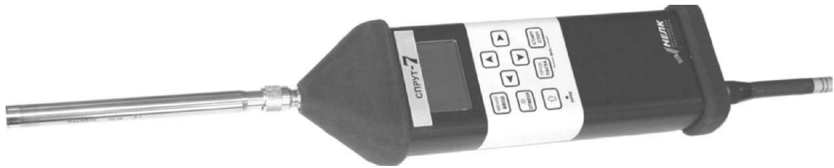
Рис. 5. Внешний вид измерительного модуля с микрофоном
