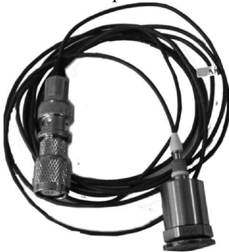
Рис. 6. Внешний вид измерительного вибродатчика
