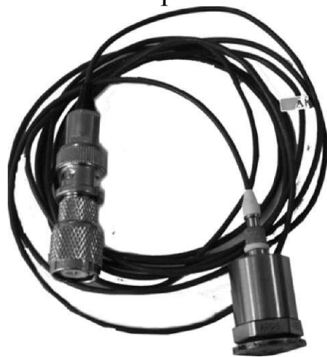
Рис. 6. Внешний вид измерительного вибродатчика
