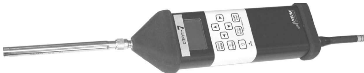
Рис. 5. Внешний вид измерительного модуля с микрофоном
