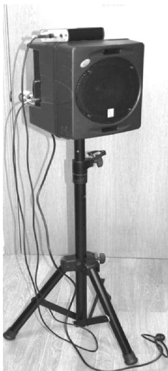
Рис. 10. Внешний вид акустической системы с подключенным модулем тестового акустического сигнала
