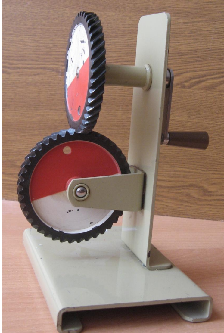
Рис. 6.2. Лабораторный макет винтовой передачи
