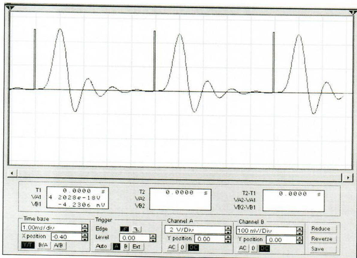
Рис. 7. Изображение импульсной характеристика ФНЧ
