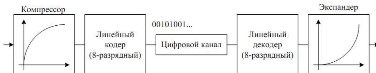
Рисунок 3.3 – Квантование с использованием аналогового компандирования
