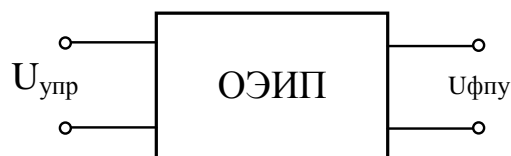
Рис.5.1. ОЭИП в виде четырёхполюсника.
