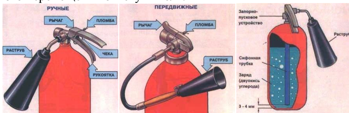
Рисунок 3 Устройство углекислотного огнетушителя
