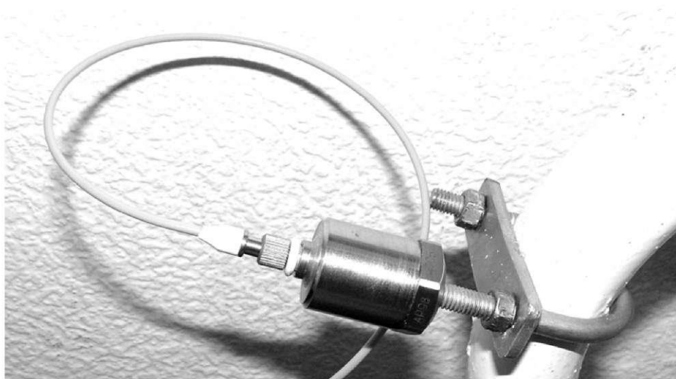
Рис. 4П. Крепление вибродатчика на батарею отопления
