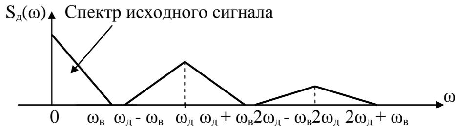
Рисунок 4 – Типовой спектр АИМ сигнала
