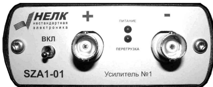
Рис. 2. Внешний вид передней панели дифференциального усилителя №1
