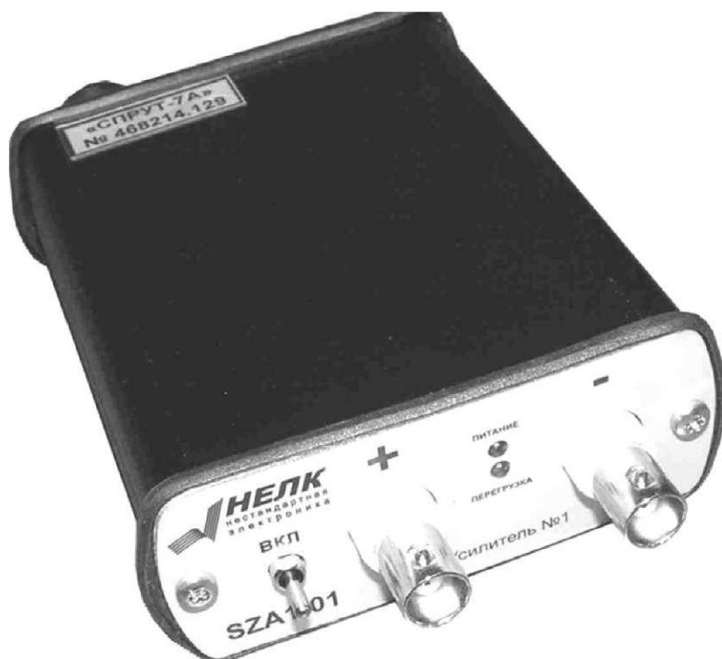
Рис. 1. Внешний вид дифференциального усилителя №1
