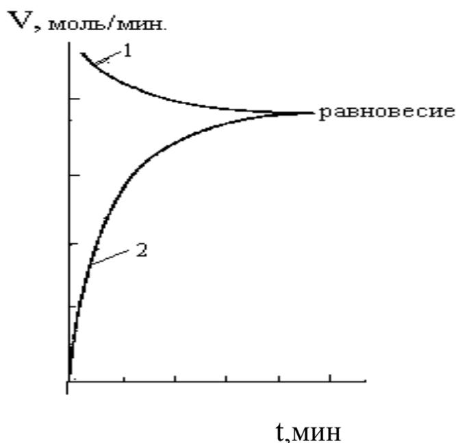
**Рис.1** Двухстороннее приближение к равновесию системы  $\text{H}_2 - \text{J}_2 - \text{HI}$  (1—образование HI; 2—разложение HI)
