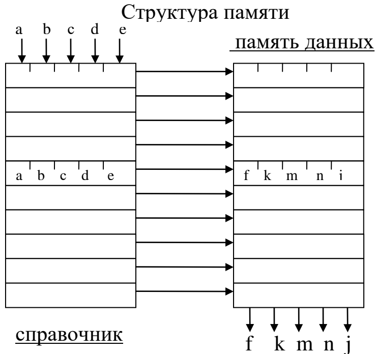
Рис.2 Структура памяти с адресацией по содержанию (ПАС)
