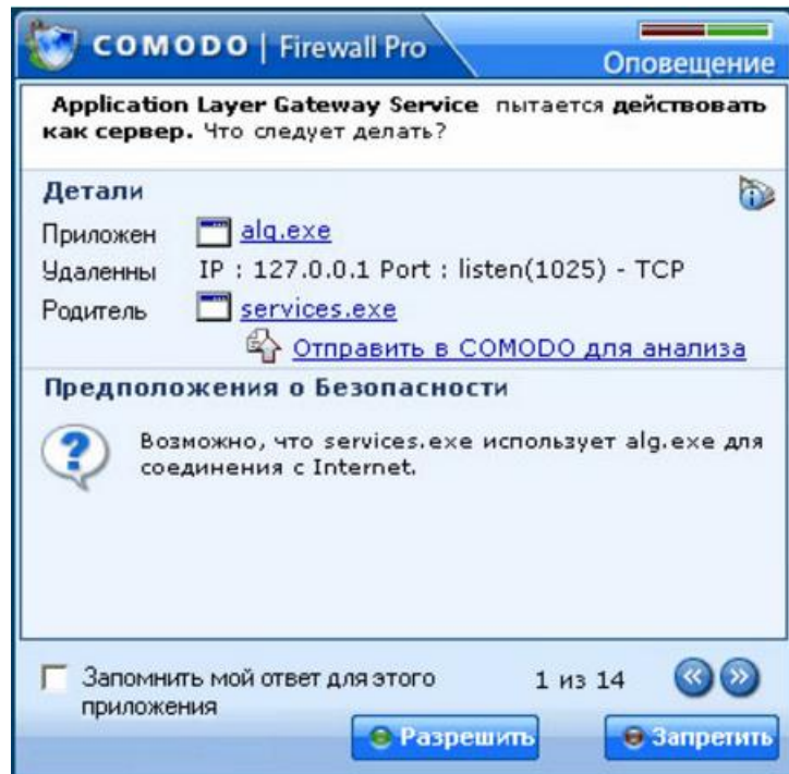
Рис. 3 – Comodo Firewall выявил программу, использующую сеть
