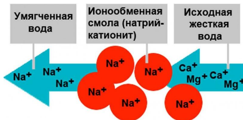
Рисунок 1.1 – Схема метода ионного обмена
