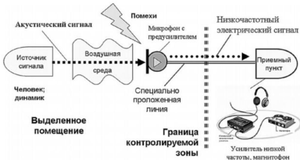
Рисунок 3 - Перехват речевой информации с помощью диктофона
