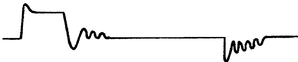
Рисунок 31 – Осциллограмма бесконтактной системы с датчиком Холла
