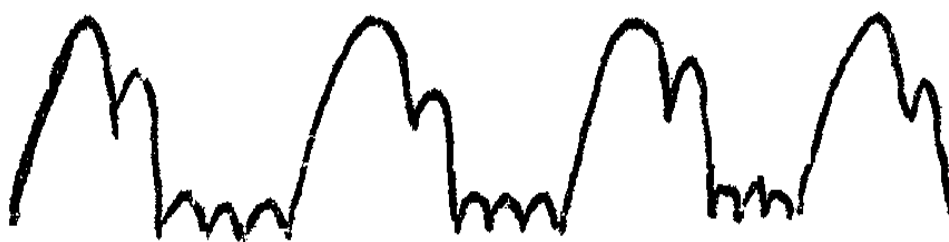
Рисунок 44 – Изображение если неисправен положительный диод
