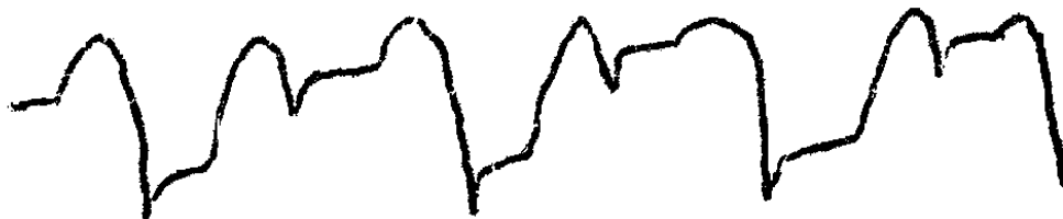
Рисунок 45 – Изображение при пробое положительного диода
