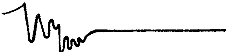
Рисунок 30 – Осциллограмма бесконтактной системы зажигания с магнитоэлектрическим датчиком
