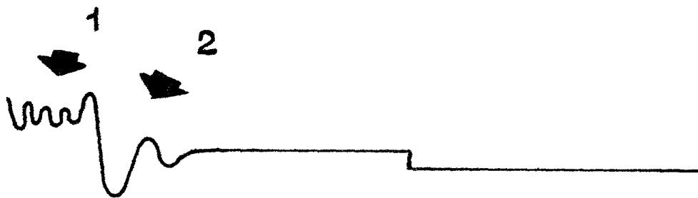
Рисунок 9 – Изображение, в случае если замкнутые витки вторичной обмотки катушки зажигания уменьшают по горизонтали колебания в зоне 1 и зоне 2
