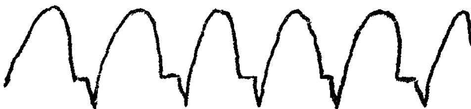
Рисунок 46 – Осциллограмма, получаемая при обрыве мотки статора
