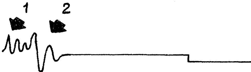
Рисунок 4 – Изображение в случае если колебания в зоне 1 и зоне 2 уменьшены как по амплитуде, так и по горизонтали
