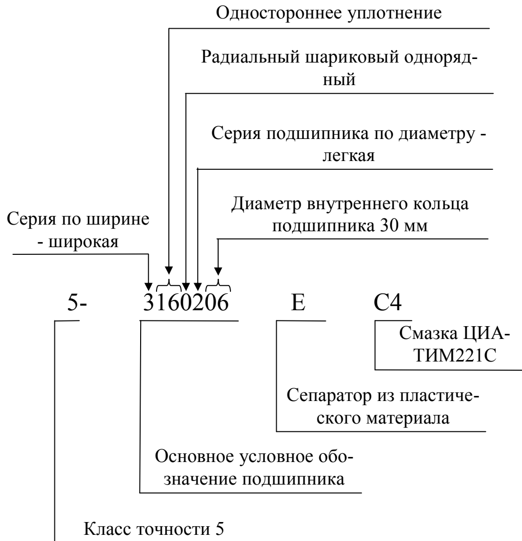
Рис. 8. Структура условного обозначения подшипника 5–3160206 E C4
