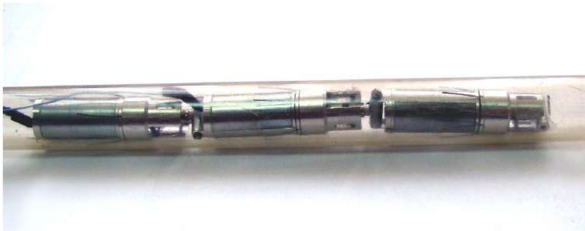
Рис. 5. Внешний вид прототипа трехзвенного вибрационного внутритрубного мобильного робота
