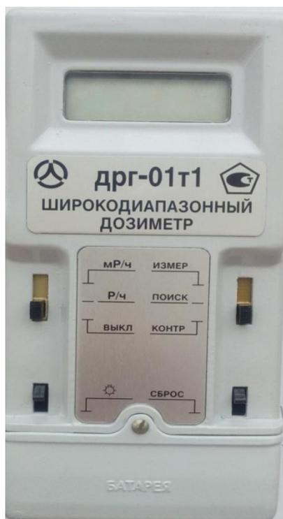
Рисунок 3.1 – Дозиметр ДРГ-01Т1
