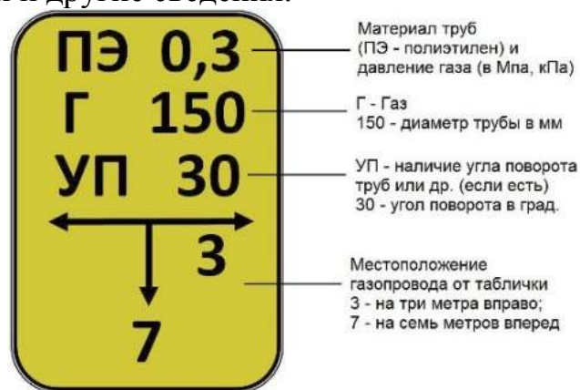
Рис. 16 – Опознавательные знаки на трассе газопроводов
