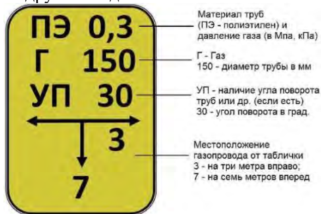
Рис. 16 – Опознавательные знаки на трассе газопроводов
