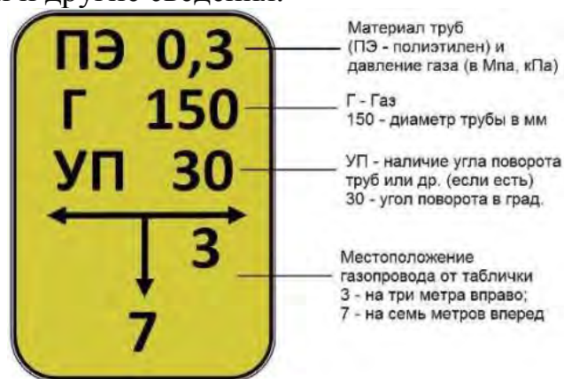
Рис. 16 – Опознавательные знаки на трассе газопроводов
