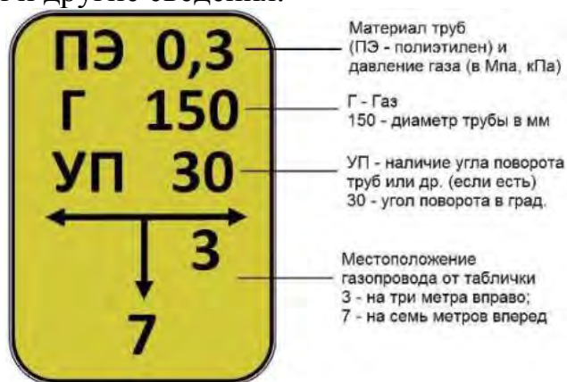
Рис. 16 – Опознавательные знаки на трассе газопроводов
