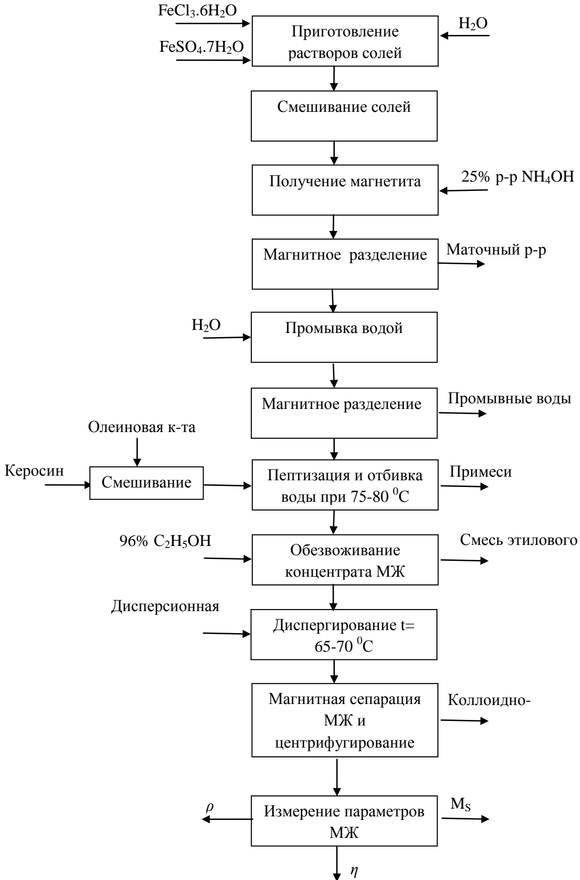
Рис. 1 - Исходная лабораторная технологическая схема по производству магнитных жидкостей
