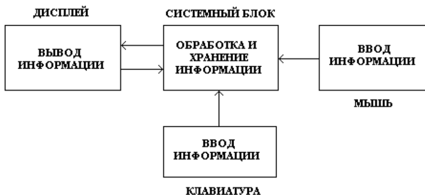
Рисунок 1 – Структурная и функциональная схемы аппаратного обеспечения персонального компьютера
