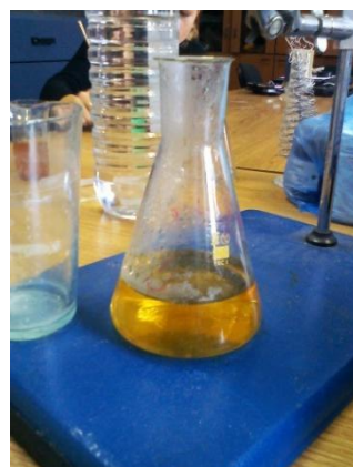
Рис. 1. Первая попытка. Слева – раствор хлорида железа (III); справа – золь тригидроксида железа.
