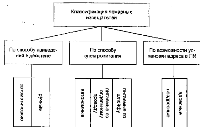
Рис.3 Общая классификация пожарных извещателей
