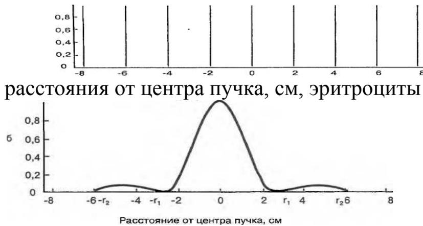
Рис. 6 Интенсивность дифракционной картины, создаваемой дифракционной решеткой (а) и мазком эритроцитов (б): а — дифракция от решетки, штрихи которой ориентированы вертикально, б — дифракция от мазка эритроцитов. Обе картины наблюдаются на экране, расположенном на расстоянии 30 см от решетки
