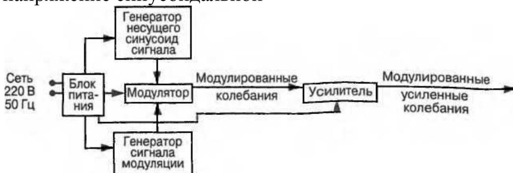
Рис. 4 Блок-схема прибора
