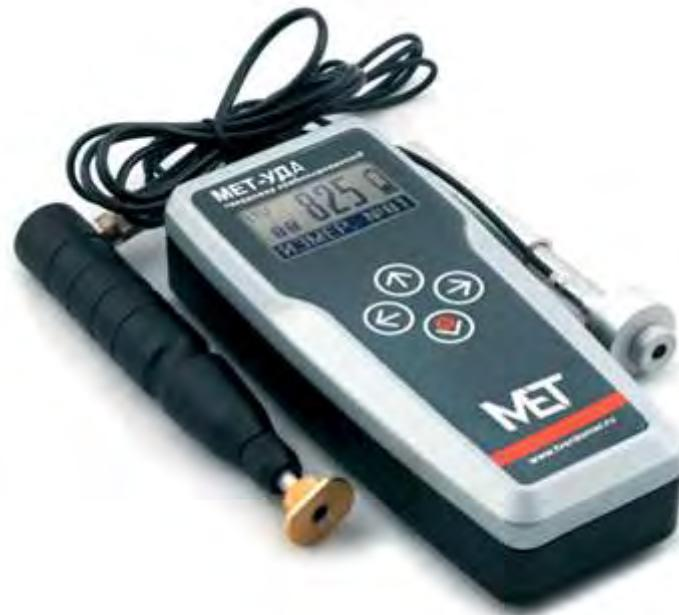
Твердомер представляет собой портативный прибор, состоящий из электронного блока и двух сменных датчиков: ультразвукового и динамического.
