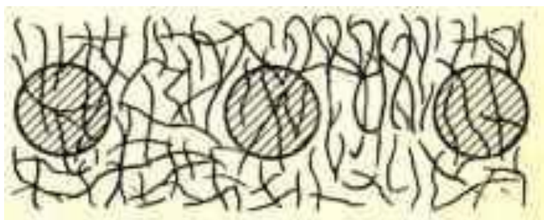
Рис. 22. Структура иглопробивного нетканого материала
