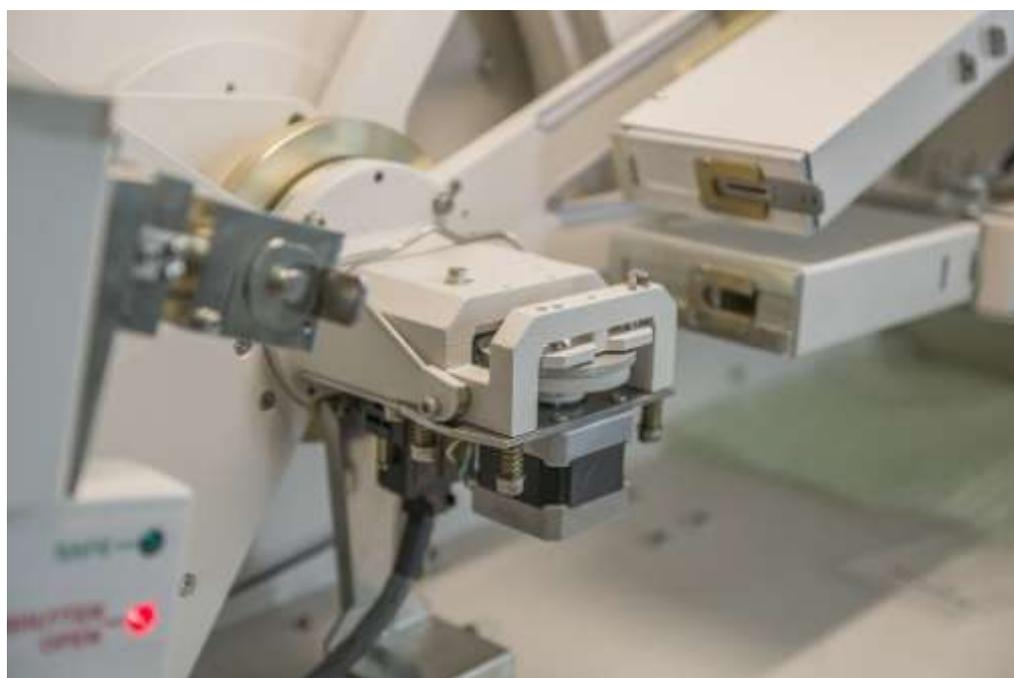
Рисунок 10 – Держатель образцов с приводом вращения (**Spinner Stage**)
