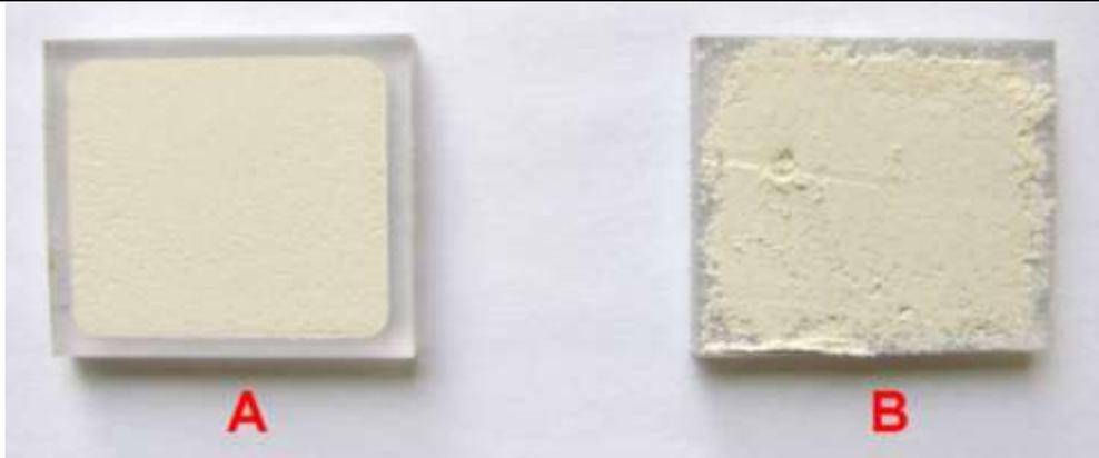
Рисунок 2 – Пример правильной (А) и неправильной (В) пробоподготовки
