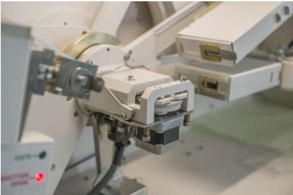
Рисунок 6 – Держатель образцов с приводом вращения (**Spinner Stage**)
