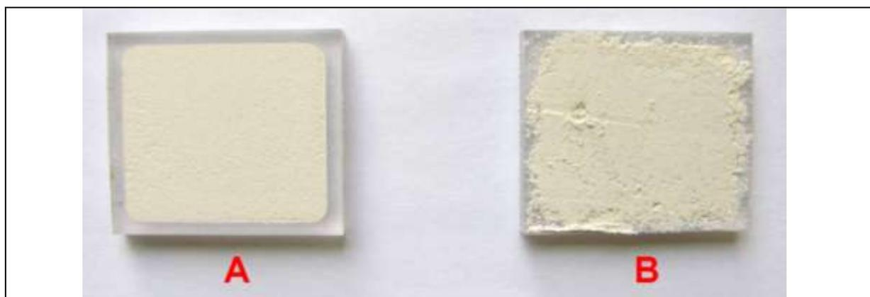
Рисунок 6 – Пример правильной (A) и неправильной (B) пробоподготовки
