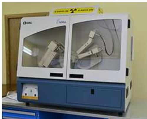
Рентгеновский дифрактометр EMMA (Enhanced Mini-Materials Analyzer - улучшенный анализатор мини-материалов) имеет компактные размеры и программное обеспечение Visual XRD с базами данных PDF-2 и PDF-4+, содержащие последние обновления ICDD
