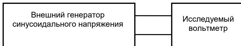
Рисунок 5 – Структурная схема измерения погрешности вольтметра.
