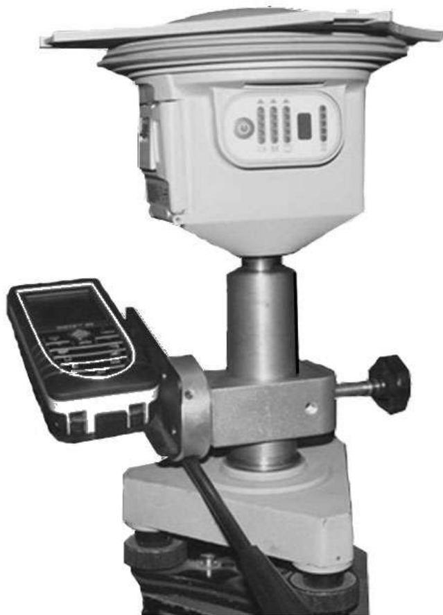
Рис..4 Лазерный прибор с адаптерами LSA 360, трегера и GPS приёмником
