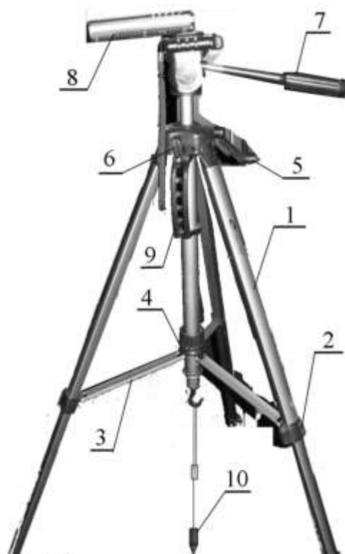
Рис. 2. Использование фотоштатива: 1-опора; 2-клипса; 3-подкос; 4-гайка; 5-рукоятка головки; 6-винт; 7-рукоятка; 8-DISTO; 9-рукоятка штатива; 10-отвес
