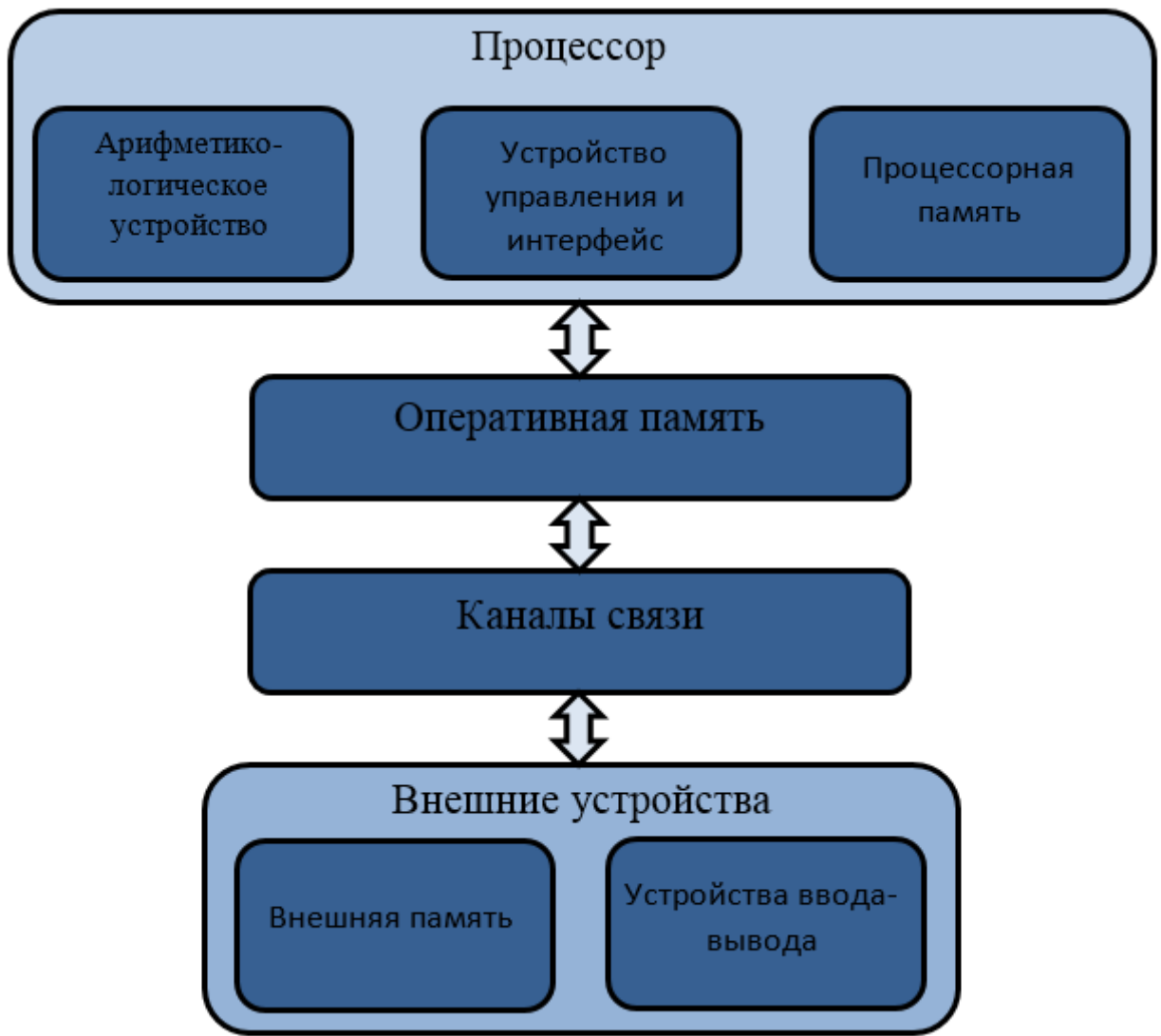
Рисунок 1 – Упрощенная структурная схема ЭВМ
