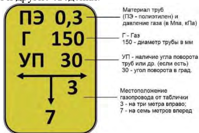
Рис. 16 – Опознавательные знаки на трассе газопроводов
