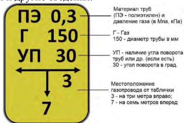
Рис. 16 – Опознавательные знаки на трассе газопроводов
