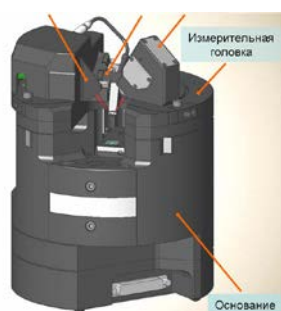
Рис. 3 – Основные части прибора (а), контроллер зондового микроскопа (б).
