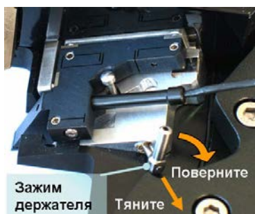
Рис. 10 – Держатель зонда, зафиксированный зажимом.
