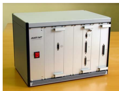
Рис. 3 – Основные части прибора (а), контроллер зондового микроскопа (б).
