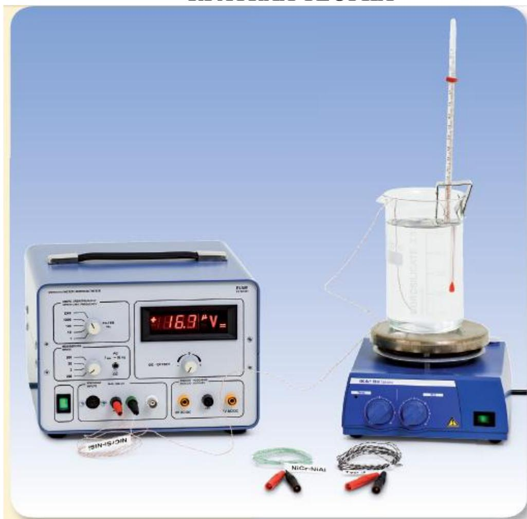
Если концы металлической проволоки имеют разную температуру, то поскольку скорости теплового движения электронов будут разными, возникнет тепловая диффузия. Поскольку тепловое движение электронов на горячем конце быстрее, чем на холодном конце, в среднем больше электронов
