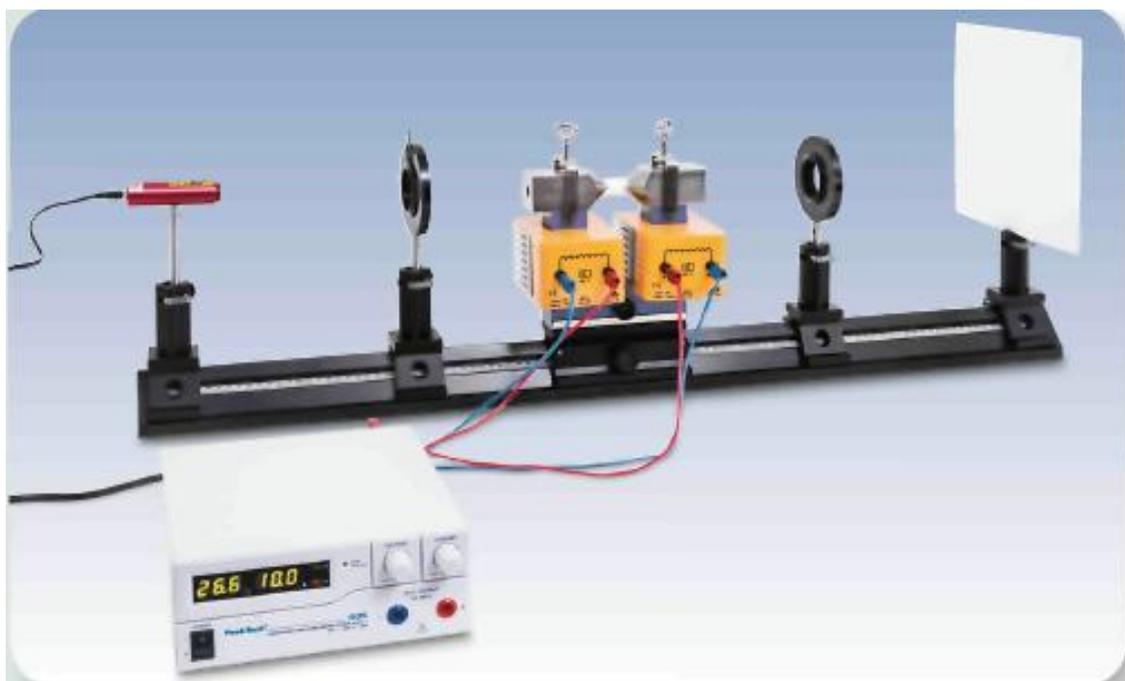
Оптически изотропные, прозрачные, немагнитные материалы становятся оптически активными в магнитном поле. Они
