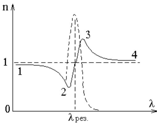
При переходе от  $n=f(\omega)$  к  $n=f(\lambda)$ , получим зависимость несколько иного вида. Пунктирная кривая характеризует поглощение света в области данной длины волны  $\lambda_{\text{рез}}$ . Участки 1-2 и 3-4 – нормальная дисперсия:  $n$  убывает с ростом  $\lambda$  и  $\frac{dn}{d\lambda} < 0$ . На участке 2-3 наблюдается
