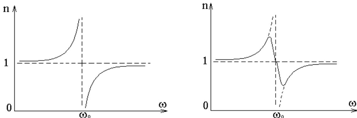
Таким образом, вблизи собственной частоты функция  $n=f(\omega)$  терпит разрыв, в этой области наблюдается сильное поглощение электромагнитных волн.
