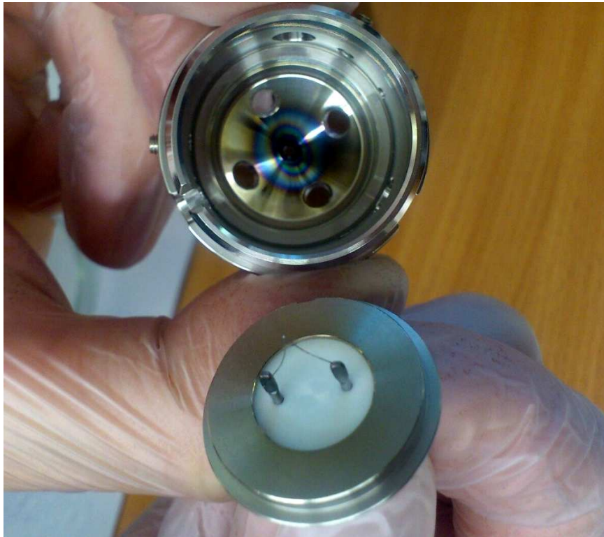
Рис. 11. Катод и корпуса электрода Венельта в разборе
