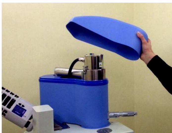
Рис. 8. Верхняя часть электронной колонны
