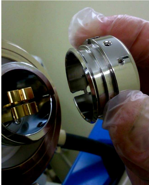
Рис. 9. Посадочное место катода
