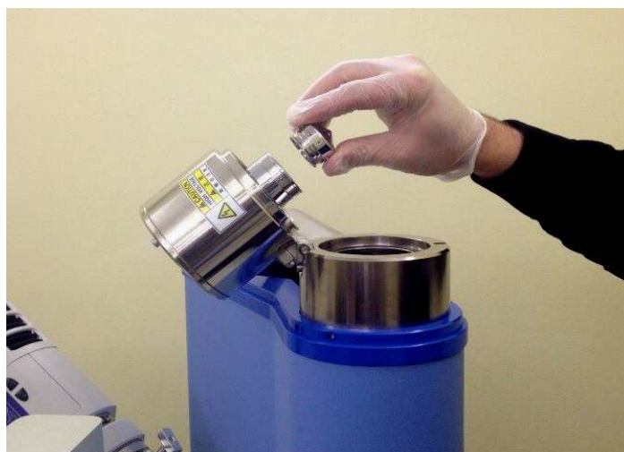
Рис. 15. Установка катода в катодный узел
