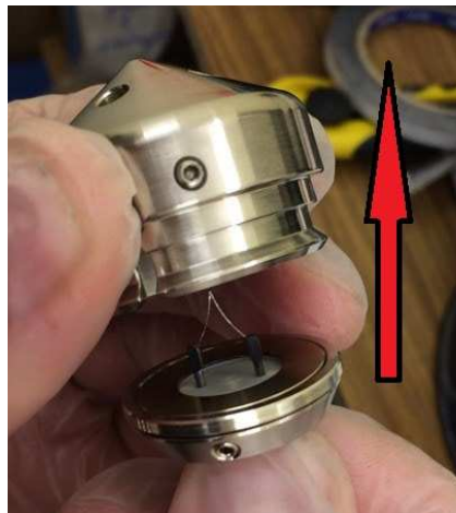
Рисунок 11 – Вставка катода в электрод Венельта
