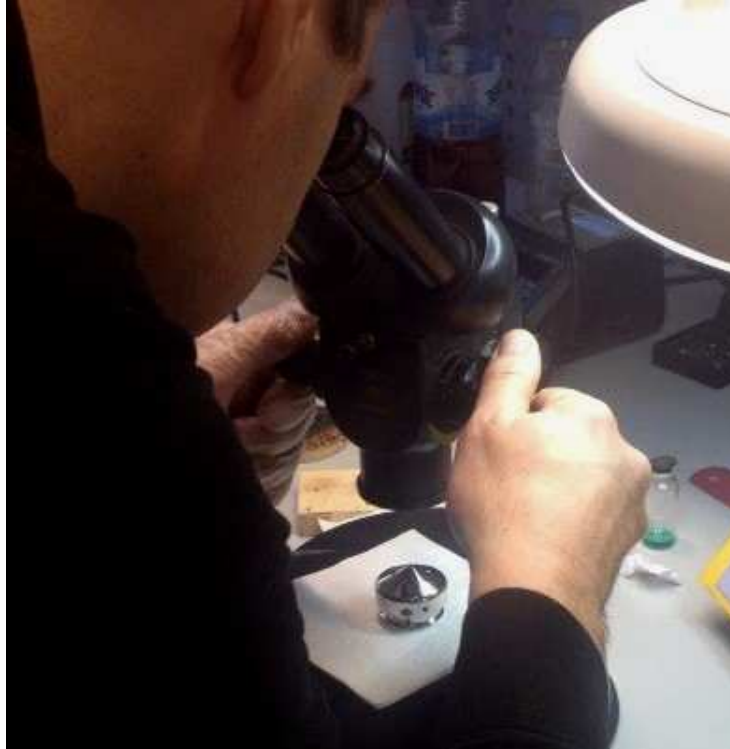
Рис. 13. Визуальный контроль качества очистки электрода Венельта
