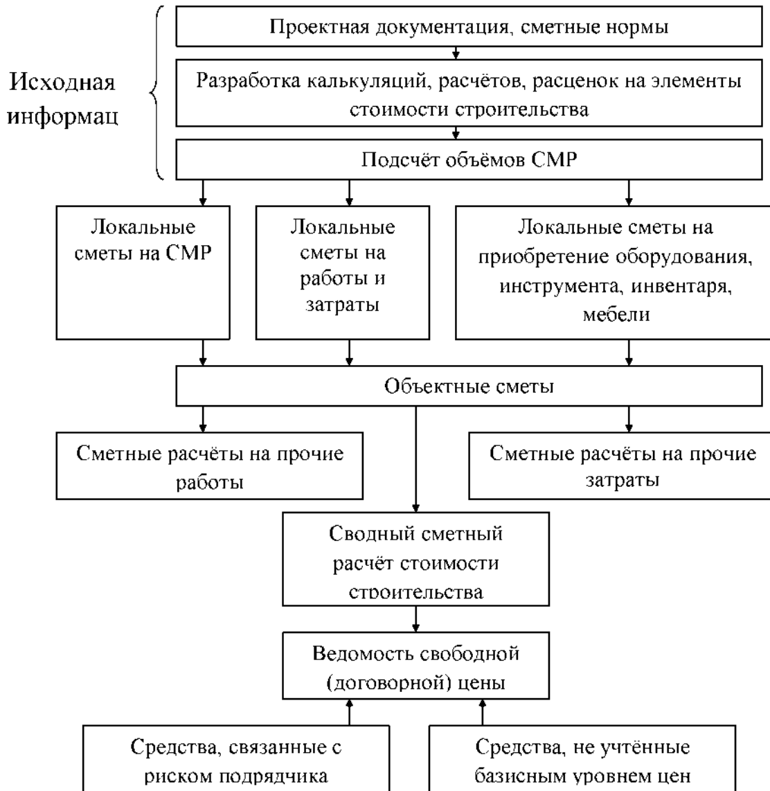
Рис. 1 Последовательность разработки сметной документации
