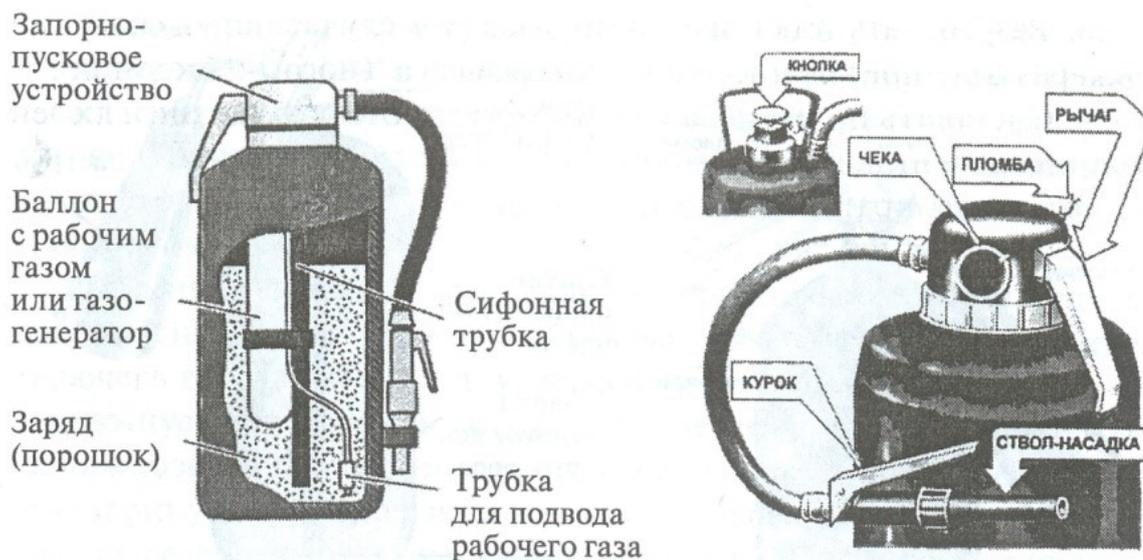
Порошковый огнетушитель со встроенным газовым источником давления ОП-5
