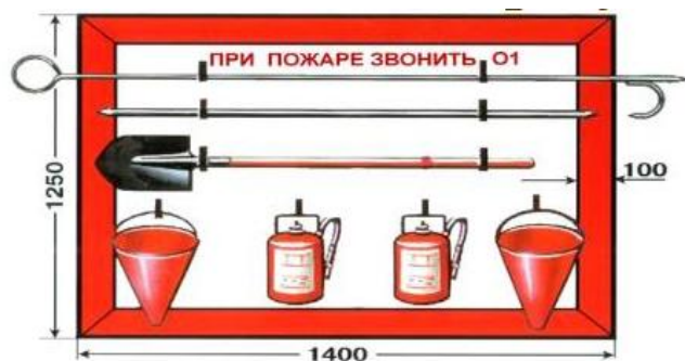
Рисунок 6 - Пожарный щит первичных средств пожаротушения
