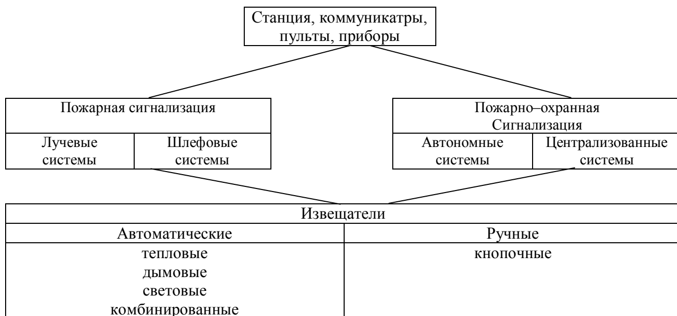
Рисунок 1 – Классификация систем пожарной и пожарно-охранной сигнализации
