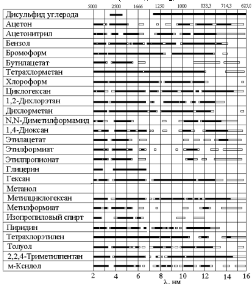
Рис. 15. Прозрачность «спектрально чистых» органических растворителей, применяемых в ИК-спектроскопии в диапазоне 5000\text{-}625\text{ см}^{-1} при толщине слоя растворителя 0.11\text{ мм} /8/. Зачерненным прямоугольникам отвечает диапазон 80\text{-}100\% пропускания, незачерненным - 60\text{-}80\% пропускания.
