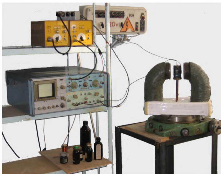
Рис.3. Фотография установки для получения азимутальной зависимости АМЭ в МЖ.
