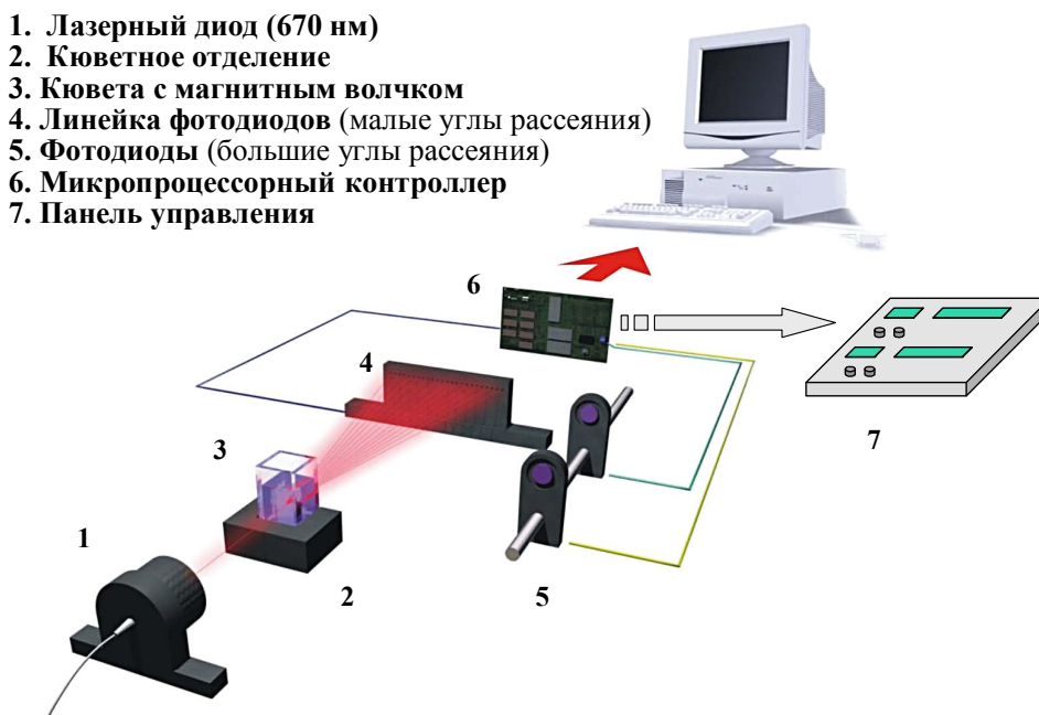
Рисунок 2 - Структурная схема анализатора «ЛАСКА-Т»
