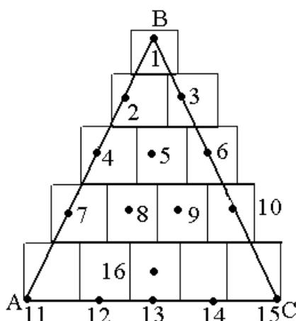
Рис.2. Точки треугольника для расчета концентраций трехкомпонентного раствора
