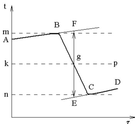
Рисунок 1 – График для определения действительного изменения температуры
