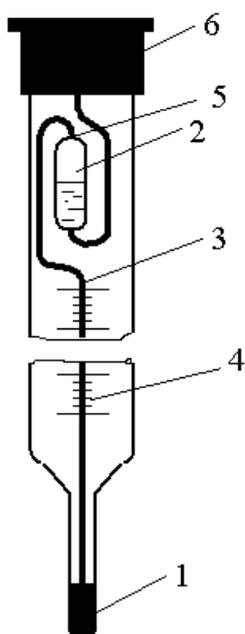
Рис.4 – Устройство термометра Бекмана.
